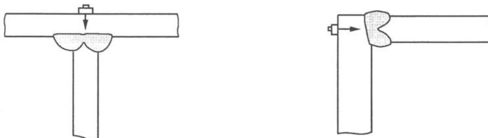
그림8. T이음 및 모서리 이음의 수직탐상 방법
